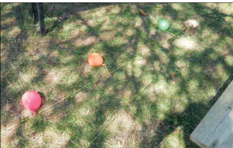
Zavorra con anello passante, cordino visibile, spezzoni di filo legati alle asole sul cordino, palloncini ripieni di acqua.
