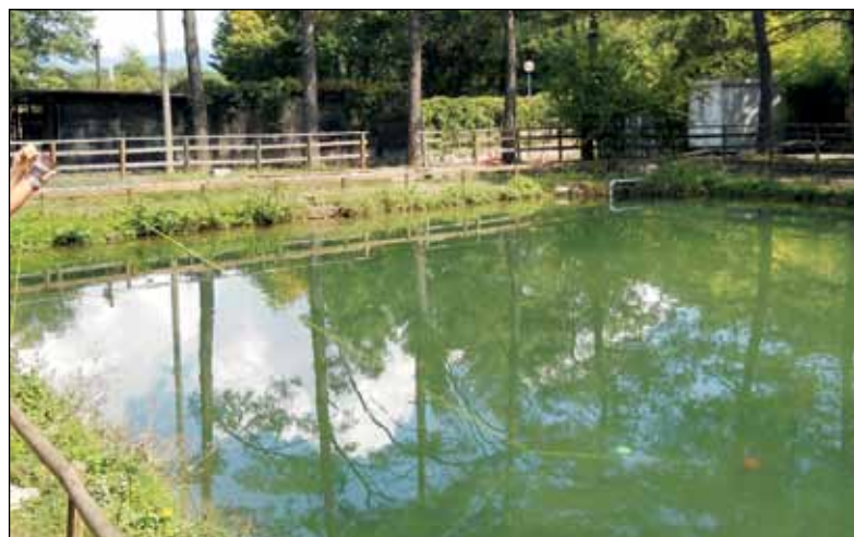
Si nota bene la deviazione apparente del tratto di corda in acqua con i palloncini posizionati a due diverse profondità.
