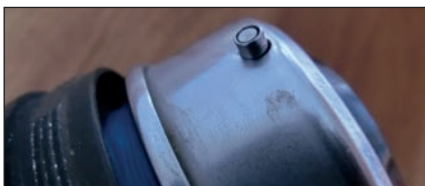
Particolare del pin che evidenzia il rivestimento cilindrico rotante che riduce l'attrito e l'usura della lenza durante il riavvolgimento.
